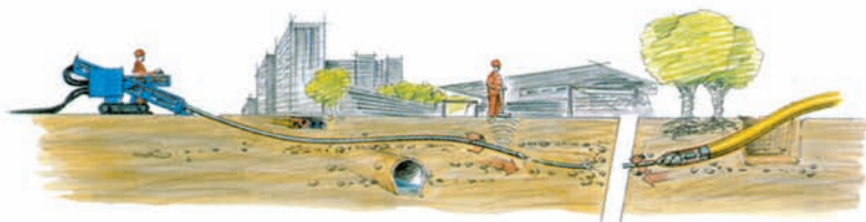
Zanja con colocación simultánea de conductos eléctricos
