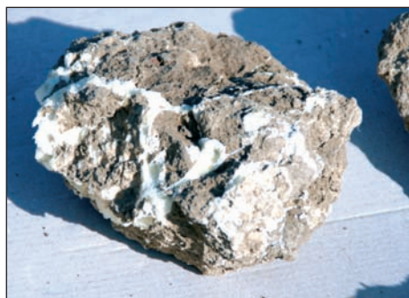
[Figura 4].- Muestra del volumen de terreno perteneciente a una zona consolidada mediante inyecciones de resina expansiva. En blanco los filamentos de resina poliuretánica inerte. (Occhi, 2010). Test Site Emilia Romagna).
