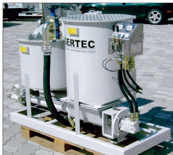
[Figura 7].- Equipos de inyección de accionamiento hidráulico modelo IS 38H.
