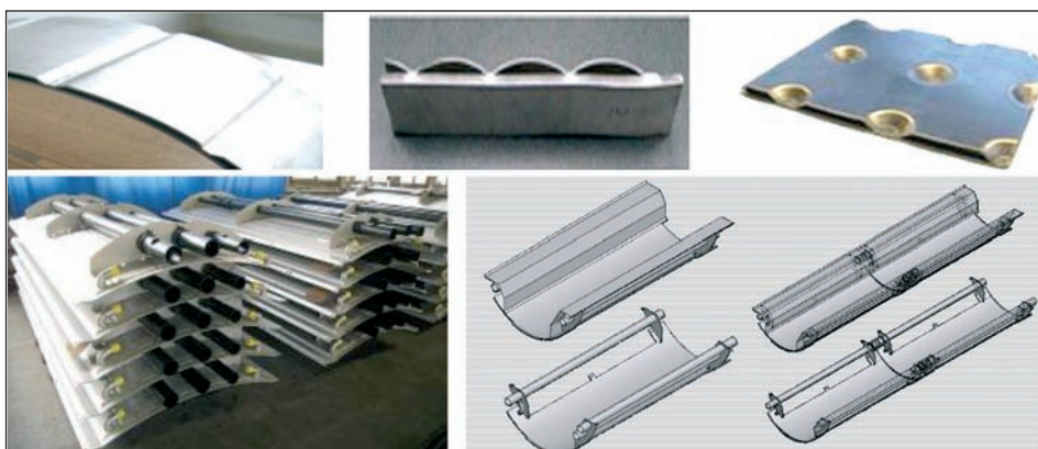
[Foto 2].- Distintas técnicas de fabricación, soldadura lineal, soldadura y soplado, y soldadura por puntos en la fabricación de intercambiadores de acero inoxidable. Construcción modular de las secciones, y ensamblaje.
