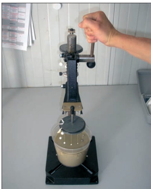
■ Aparato de arpa de bolas para medida del yield point estático del lodo bentonítico.
