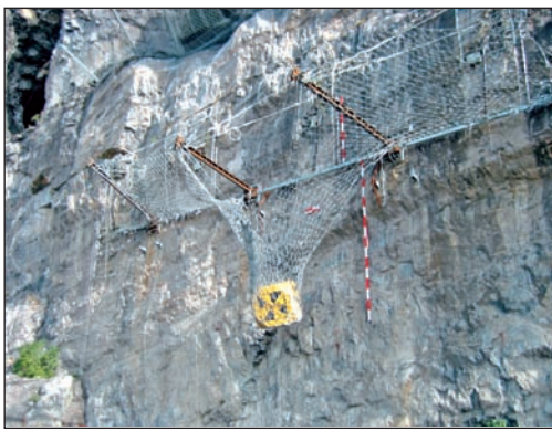
[Fig. 10].- Efecto de una carga concentrada al centro de un paño en una barrera dinámica Geobrugg RXI de protección contra desprendimientos, deflexiones del orden de los 7,5m en paños de 6mx10m (red anillos Rocco 4:1).
