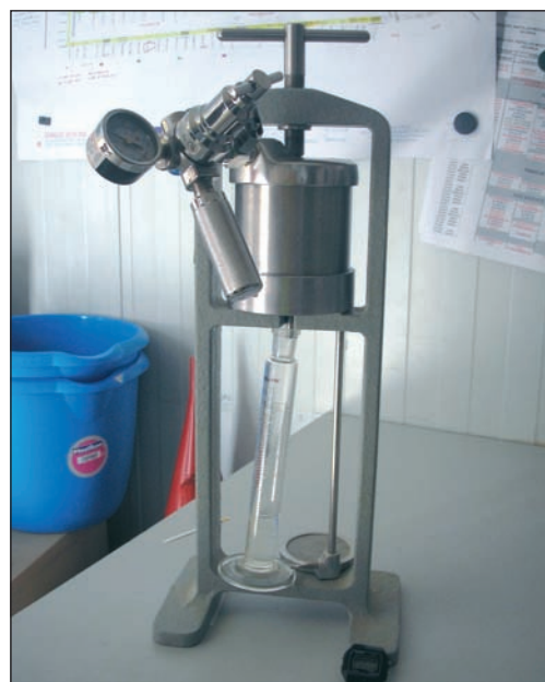
■ Filtro prensa para medida del filtrado y cake .
